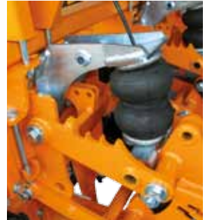
ELŐ-TERHELŐ RENDSZER PNEUMATIKUS GUMIHARANGGAL OPCIONÁLIS
