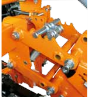
ELŐ-TERHELŐ RENDSZER ÁLLÍTHATÓ RUGÓVAL ALAPSZERELT
