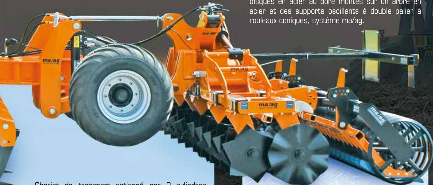
Chariot de transport actionné par 2 cylindres hydrauliques munis d'un dispositif de sécurité avec soupape d'arrêt. Roues majorées, demi-essieux à 8 trous.
