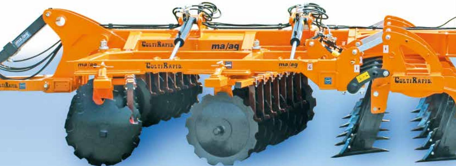
Double groupe de disques à disques bombés dentés. Réalisé avec des disques en acier au bore montés sur un arbre en acier et des supports oscillants à double palier à rouleaux coniques, système ma/ag. Les groupes de disques sont disposés en losange, système ma/ag breveté. Réglage manuel de l'angle de travail dans différentes positions.
